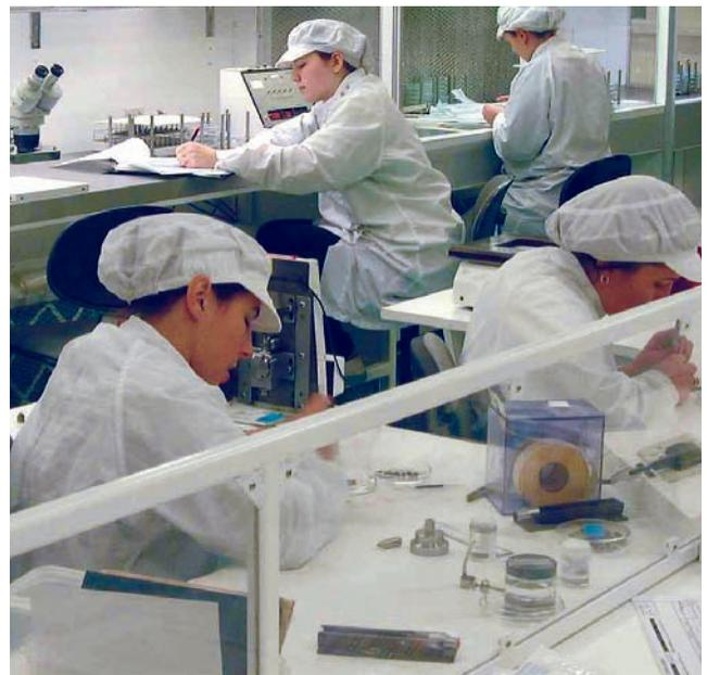
*Tous les roulements de précision Barden sont montés dans des conditions rigoureuses en salle blanche.*
