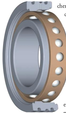
dans la bague extérieure du roulement. Le nombre et la dimension des trous de lubrification peuvent varier selon l'application, ils sont reliés par une gorge radiale de distribution de l'huile. Les joints toriques de chaque côté de la gorge de distribution empêchent les pertes et assurent que la bonne quantité d'huile soit desservie au bon endroit. Contacter Barden pour de plus amples détails.
